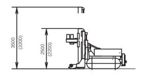
Kinematisch mögliche Schwenkbereiche. Abhängig von der Ausstattung sind Abweichungen hiervon möglich.
