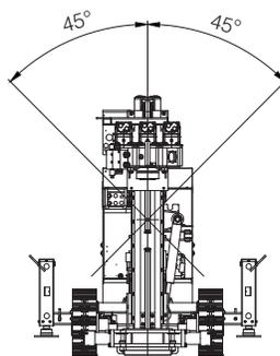
Kinematisch mögliche Schwenkbereiche.
