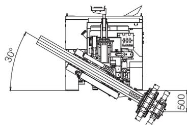
Kinematisch mögliche Schwenkbereiche.
