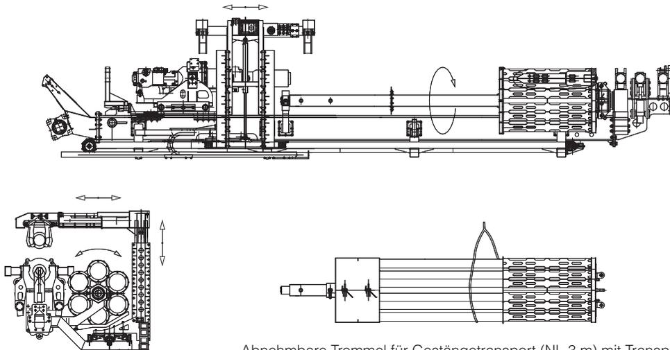
Abnehmbare Trommel für Gestängetransport (NL 3 m) mit Transportsicherung
